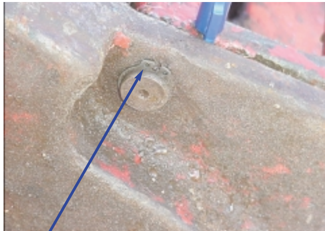
مسمار المزلاج مركب فوق حلقة الحافظة
