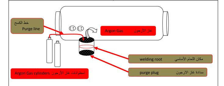
شكل توضيحي يبين كيفية تجمع غاز الارجون بداخل الوعاء
